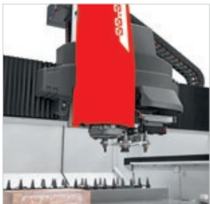
Револьверный магазин на рабочей голове на 8 мест для сокращения времени замены инструментов, используемых чаще всего.
